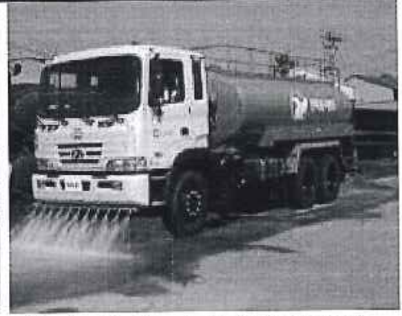
Xe chuyên dụng tưới phun nước mặt đường giảm thiểu bụi phát tán
