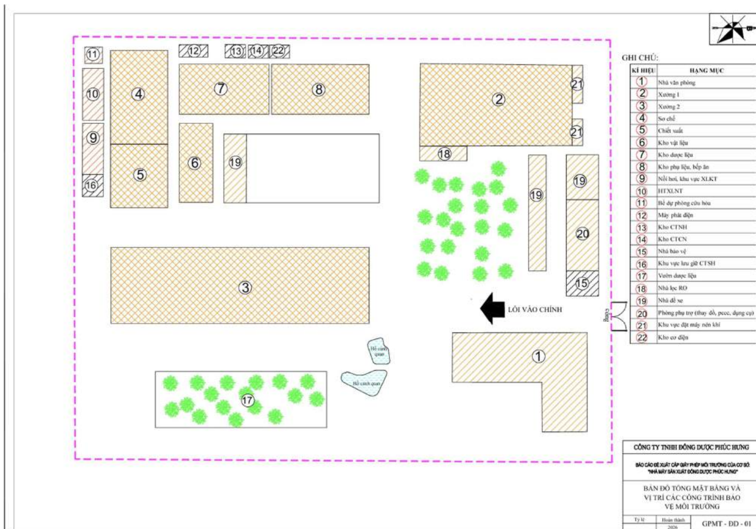
Hình 1. 6. Mặt bằng bố trí các hạng mục công trình của cơ sở
