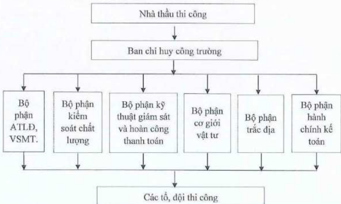
Hình 1. 21. Sơ đồ quản lý và tổ chức thi công tại công trường
