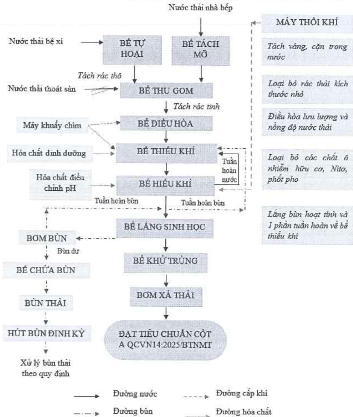
Hình 3.7. Sơ đồ công nghệ HTXL nước thải công suất 1.210 m 3 /ngày đêm
